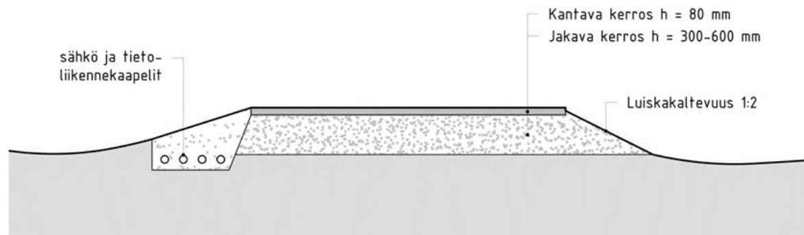
Periaatekuva uuden ja perusparannettavan tien rakenteesta.
